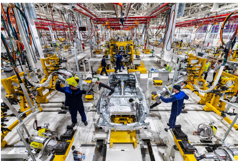
Abb. 1: NIMAK-Handschweißzangen in der Produktion des neuen Montagewerks von Mercedes-Benz in Russland. Foto: Mercedes-Benz AG
