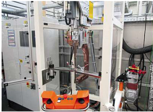
Die Versuchsanlage bei Volkswagen: Seit mehr als einem Jahr erfolgen die Schweißversuche mit den vibrierenden Elektroden auf Basis der „magneticdrive“-Technologie von Nimak.
