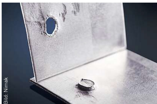
Ausknöpfversuche an Aluminiumprüfungskörpern zeigen, dass das Buckelschweißen von Aluminium erstmalig mit „magneticdrive“ von Nimak möglich ist.
