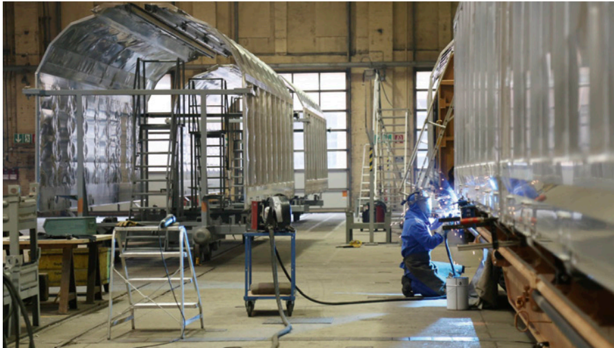
Blick in die Fertigung von Waggonbau Niesky: Auch im Schienenfahrzeugbau spielen Profilkonstruktionen und Rohrstrukturen eine zunehmend wichtige Rolle – hier eröffnet das einseitige Punktschweißen neue Möglichkeiten. (Foto: André Schulze)
