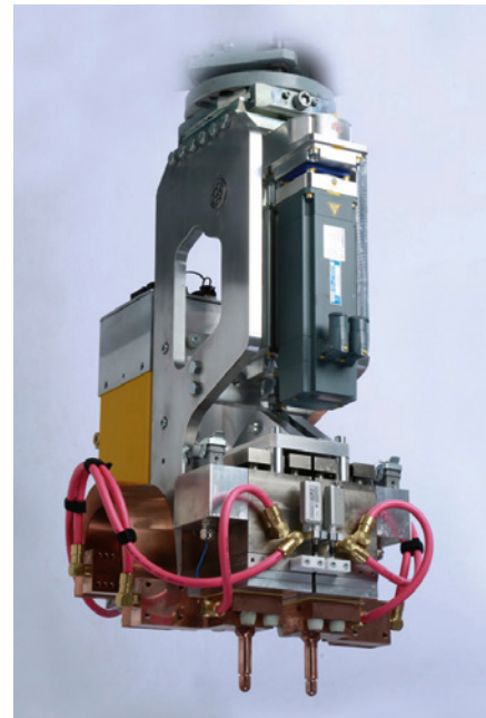
Der von Nimak entwickelte „Doppelpunker“ mit zwei Elektroden, die gleichzeitig von einer Seite auf das Blech drücken, erlaubt auch das Fügen an Stellen, die nur von einer Seite aus zugänglich sind. (Foto: Nimak GmbH)
