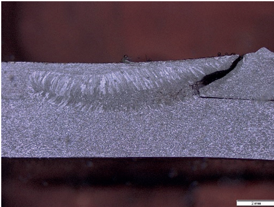
Bild 7: Schliffbild mit ausgetretener Schmelze beim SSSW mit F_E = 1,5 \text{ kN} , I_S = 45 \text{ kA} , t_S = 160 \text{ ms}
