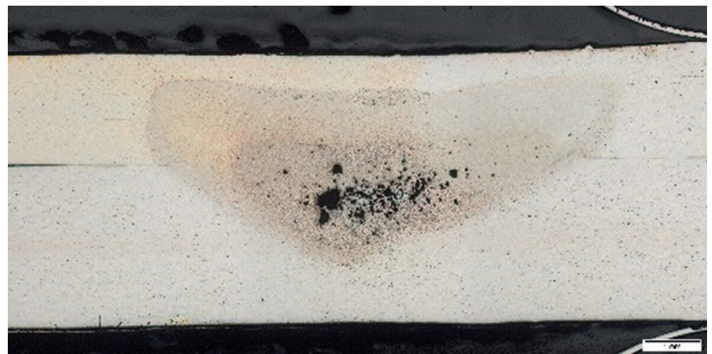
Bild 13: Schliffbild der einseitig geschweißten Verbindung
