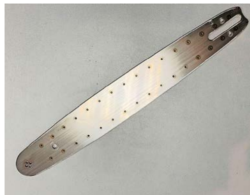
Eine Führungsschiene für eine Motorsäge, bei der die vielen Schweißverbindungen noch gut zu erkennen sind
